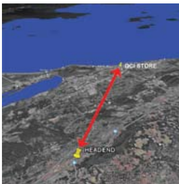
Diagrama del enlace de microondas desde la cabecera ala oficina central.
