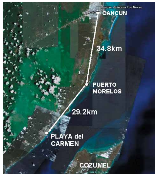
Dos TVLINKS en serie transportan un canal de TV de Cancún a Puerto Morelos y Playa del Carmen, en la Riviera Maya de México
